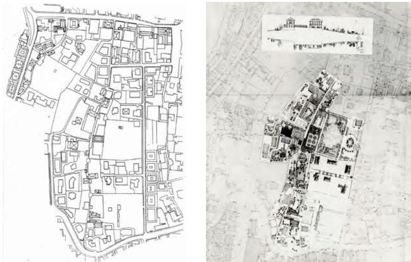
Fig.5 Suddivisione in lotti della zona di rilievo. Scala 1: 1000. A destra: Sovrapposizione finale del rilievo in scala 1:500 , ridotto, e sovrapposto alla carta 1: 1000
