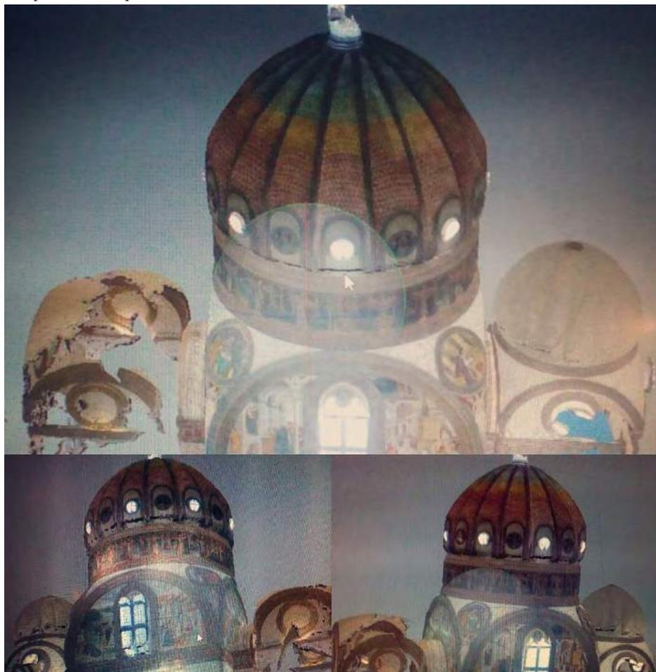
*Fig.2 Fotomodellazione tridimensionale dell'interno della cappella Portinari.*
