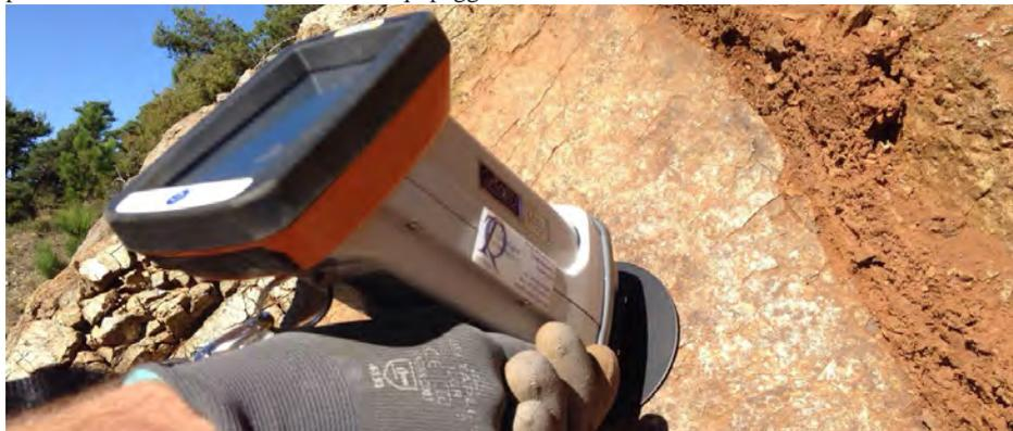
Fig.1 Analisi in situ mediante spettrometro XRF portatile su roccia madre.
