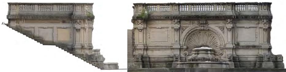
Fig. 7 Sezione della scalinata elaborata tramite la tecnica SFM
