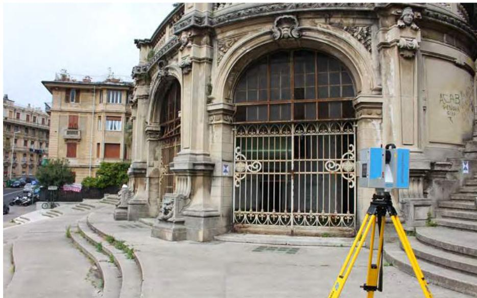
Fig. 3 Esecuzione della campagna di rilievo laser con scanner Z+F Imager 5006h
