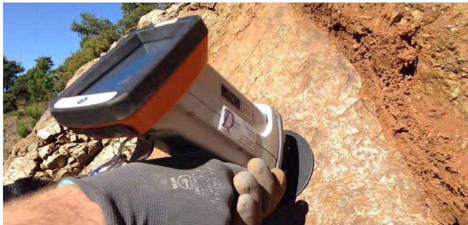
*Fig.4 esempio di analisi su roccia tramite FP-EDXRF*
